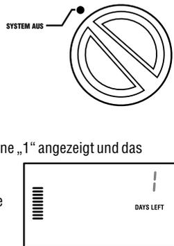
4. Stellen Sie den Drehschalter wieder in die Position **BETRIEB**. In dieser Position bleiben Zeit, das **OFF**-Symbol (Aus), eine **Nummer** und das **DAYS LEFT**-Symbol (verbleibende Tage) eingeblendet.
